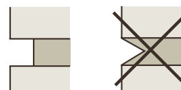
richtiges Auskratzen der Fuge!
